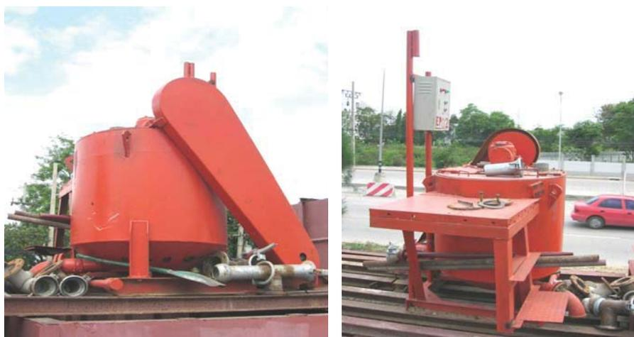
รูปที่ 5.3 เครื่องผสมของเหลวขุ่นเสถียรภาพหลุมเจาะ
