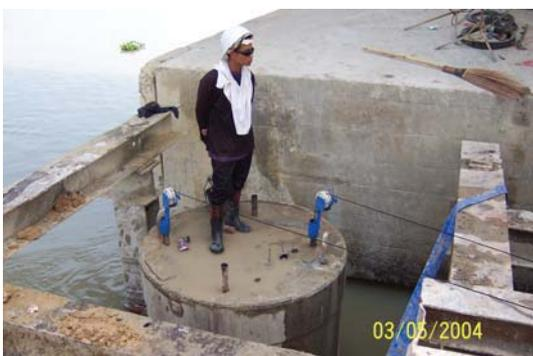
รูปที่ จ.4 การทดสอบความสมบูรณ์ของเสาเข็มเจาะ
