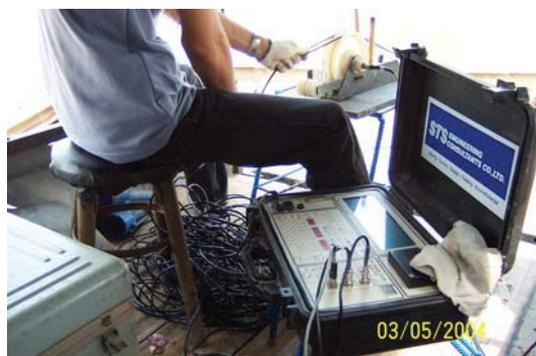
รูปที่ จ.5 เครื่องมือทดสอบ Sonic Logging Test
