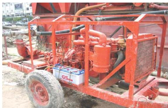
รูปที่ 5.5 เครื่องสูบของเหลวพยางเสถียรภาพเข้าไปในหลุมเจาะขนาดเส้นผ่านศูนย์กลางท่อ 4"
