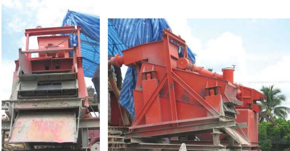
รูปที่ 5.2 เครื่องแยกตะกอนทรายออกจากของเหลวขุ่นเสถียรภาพหลุมเจาะ (Desander Unit)
