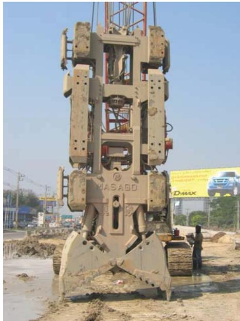
รูปที่ 5.1 เครื่องจักรขุดดินสำหรับก่อสร้างผนังพีคแบบ Cable Hang Grab
