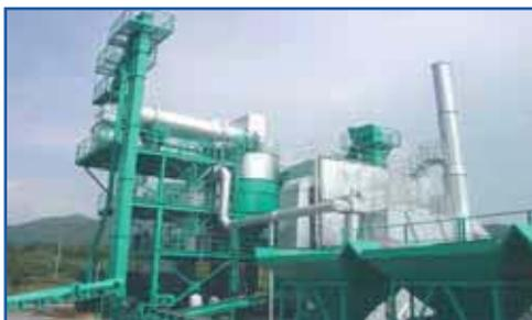
รูปที่ 10.1 Central Plant Mix แบบ Batch Plant สำหรับผสมวัสดุ Recycling โดยเฉพาะ
