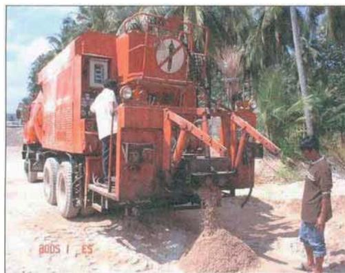
รูปที่ 2 เครื่องจักรงาน Slurry Seal ขณะปรับเทียบหิน
