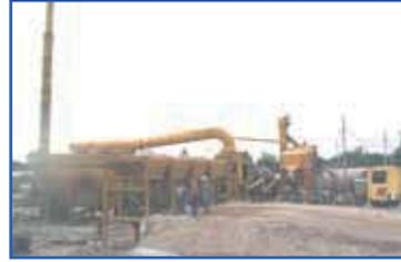
รูปที่ 2 โรงงานผสมแอสฟัลต์คอนกรีตแบบชุดและแบบผสมต่อเนื่อง
