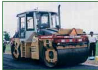
รูปที่ 15 รถบดล้อเหล็กสันสะเทือนชนิด 2 ล้อ
