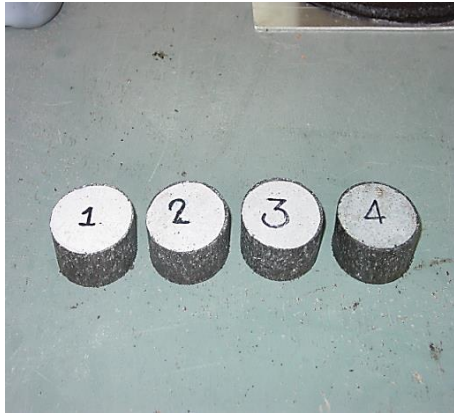
รูปที่ 3.26 ก้อนตัวอย่างก่อนทดสอบอบแห้งที่อุณหภูมิ 60 °C
