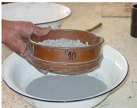
รูปที่ 3.20 เตรียมตัวอย่างวัสดุมวลรวม ส่วนที่ผ่านตะแกรงเบอร์ 10
