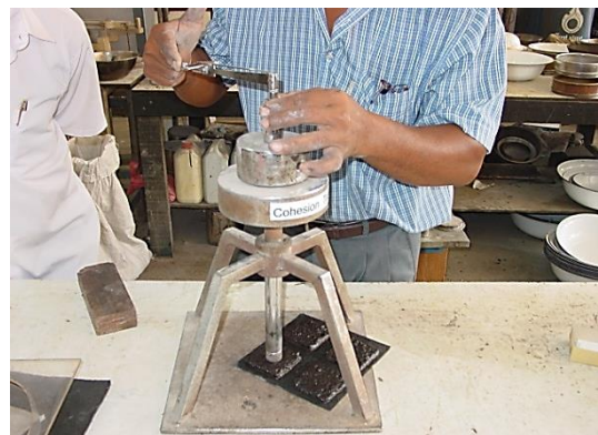
รูปที่ 3.8 หัวกดหมุนได้อย่างอิสระบนแผ่นตัวอย่าง โดยไม่เกิดการเสียหาย
