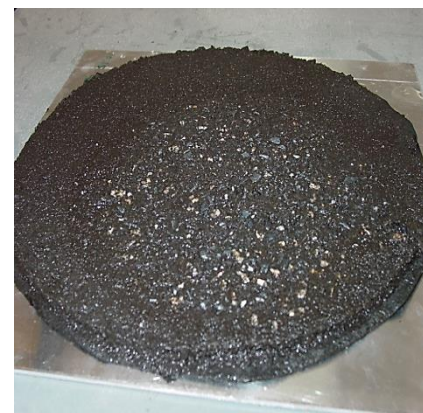
รูปที่ 3.17 ถอดแผ่นตัวอย่างออกจากภาตแล้วล้างให้ สะอาด
