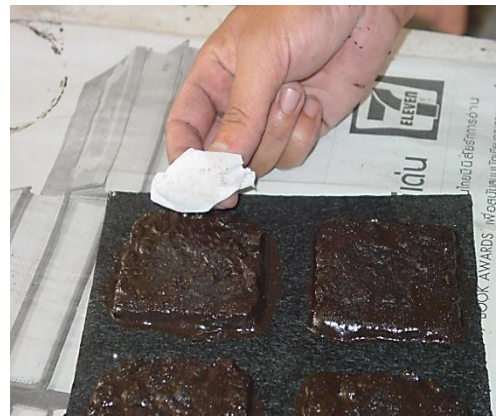
รูปที่ 3.6 การใช้กระดาษซับไม่มีแอสฟัลต์เป็นกระดาษซับ
