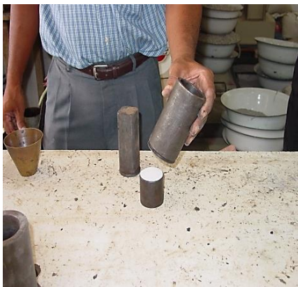
รูปที่ 3.24 ติดตั้ง Plunger ตัวบน
