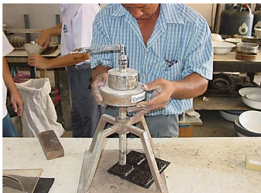
รูปที่ 3.7 เครื่องมือทดลอง Hand Torque Tester
