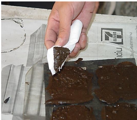
รูปที่ 3.5 การใช้กระดาษซับเป็นสีน้ำตาล
