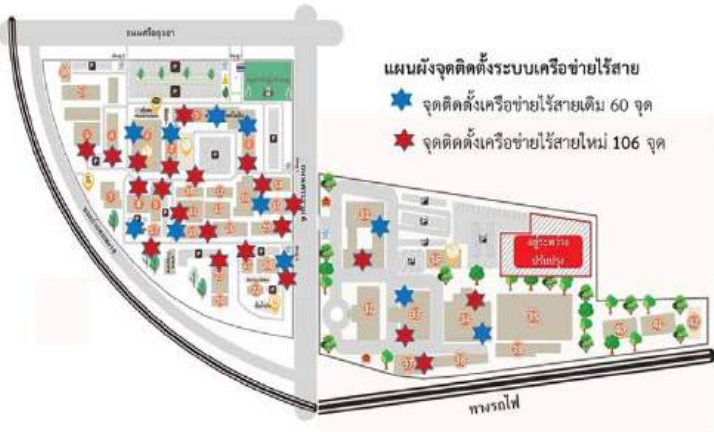
แผนผังแสดงจุดติดตั้งเครือข่ายไร้สาย กรมทางหลวง
