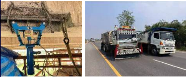
การดำเนินการตรวจวัดแรงดึงในลวดอัดแรง และตรวจวัดพฤติกรรมของสะพานด้วยน้ำหนักจากรถบรรทุกในภาคสนาม
